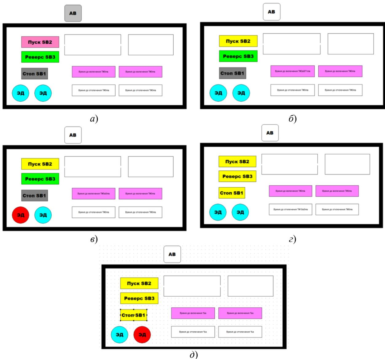
Рисунок 4 – Этапы управления реверсивным электроприводом с использованием среды разработки приложений для программируемых контроллеров CoDeSys
