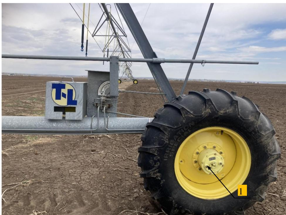
Рисунок 1 – Общий вид фрагмента опорной башни с колесом с бескамерной шиной типа 14,9R24 DR-105 TL Tyrex Agro
