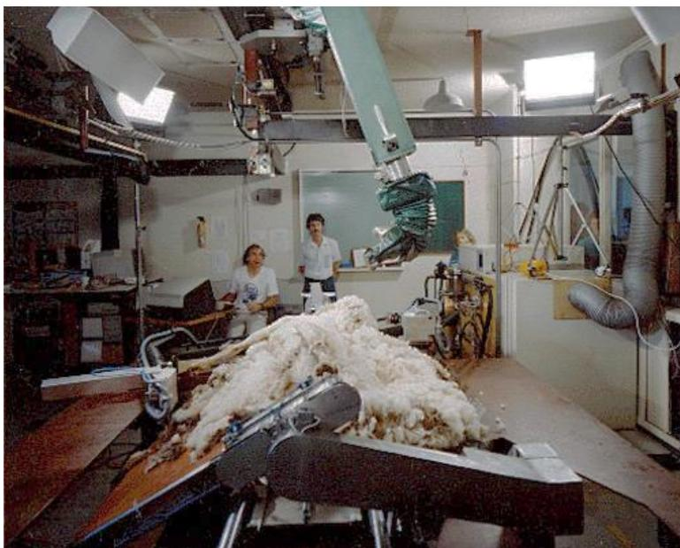
Рисунок 2 – Автоматизированная станция для стрижки овец
