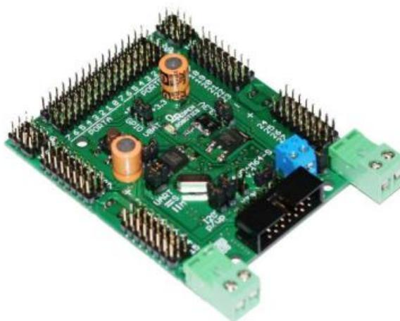
Рисунок 4 – Модуль OR-AVR-M128-S
