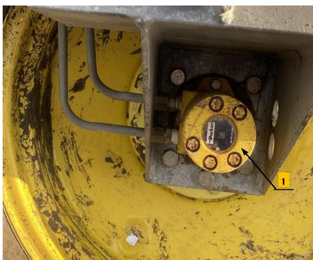
Рисунок 4 – Общий вид колеса опорной башни с гидравлическим двигателем
