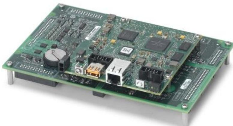
Рисунок 2 – Система управления на базе контроллера Single-board RIO
