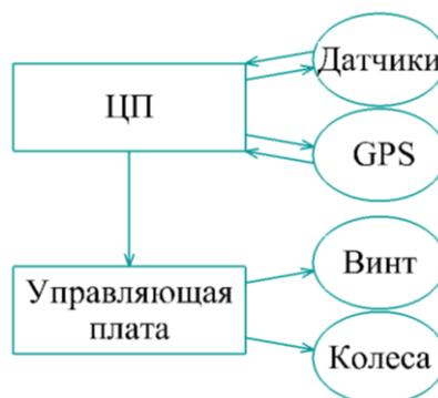
Рисунок 3 – Структурная схема управления автоматизированной газонокосилкой
