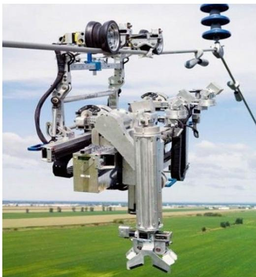
Рисунок – Способность робота преодолевать точки крепления проводов к натяжным зажимам
