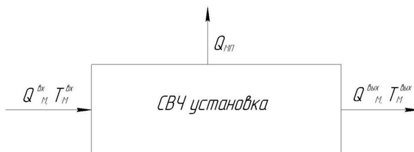
Рисунок 2 – Расчетная схема объекта моделирования:  $Q_M^{вх}$  – количество теплоты потока молока, входящего в СВЧ установку;  $Q_M^{вых}$  – количество теплоты потока молока, выходящего из СВЧ установки;  $T_M^{вх}$  – температура молока на входе в СВЧ установки;  $T_M^{вых}$  – температура молока на выходе из СВЧ установки;  $Q_{мп}$  – количество тепла, затрачиваемого на нагрев молокопровода
