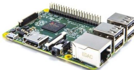
Рисунок 1 – Одноплатный ПК Raspberry Pi 2 Model B
